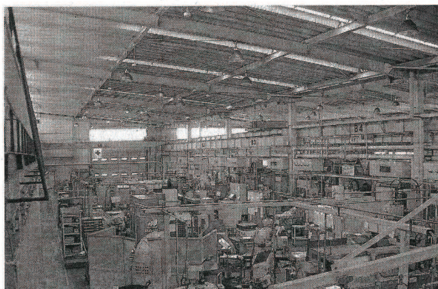
スカイプランニングの天窓を設置するなどし、太陽光を採光している精密機械工場（同社提供）
